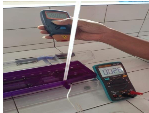
(d) Uji Suhu pada Kecepatan 3000 rpm
